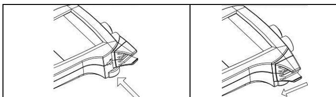
Le clip d'électrode est un support d'électrodes qui peut être placé à côté de l'affichage sur chaque côté du boîtier
