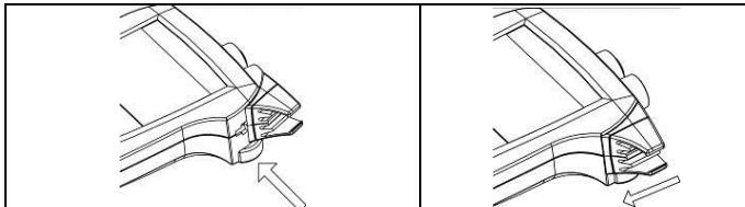
La pince d'électrode correspond à un porte-électrode pouvant être positionné sur n'importe quel côté de l'enceinte.
