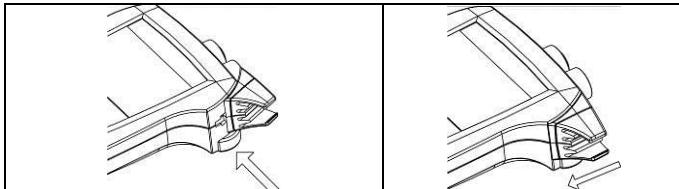
El clip para electrodo es un soporte para el electrodo que puede colocarse cerca de la pantalla en cualquier lateral de la carcasa.
