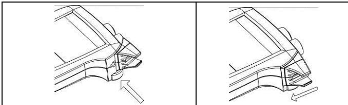
A presilha do eletrodo é um suporte que pode ser colocado próximo ao display em qualquer lado do gabinete.
