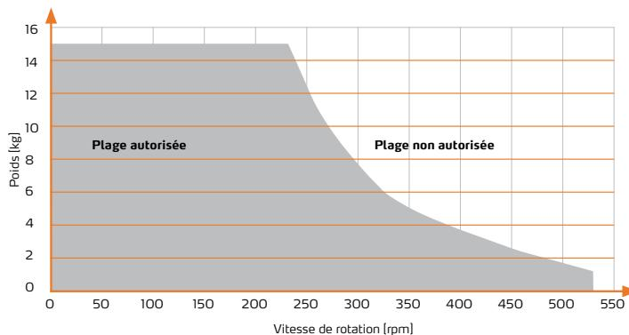
Les valeurs affichées ont été déterminées avec des blocs de poids plats et sans assemblages supplémentaires sur la plateforme de l'agitateur et ne sont utilisées que pour l'orientation. L'utilisateur doit déterminer et définir la vitesse de rotation maximale réelle possible de manière appropriée, en fonction du processus au cas par cas. Il est impossible de donner des conseils du fabricant pour les divers scénarios à cause des paramètres spécifiques à l'application.
